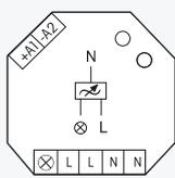
**Télévariateur universel. Power MOSFET jusqu'à 400W. Reconnaissance automatique des types de lampes. Pertes en attente de 0,1 Watt seulement. Valeur de luminosité minimale réglable. Avec enclenchement chambre d'enfant et de somnolence.**
