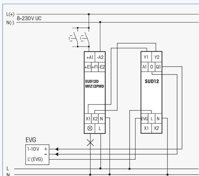
En utilisant cette connexion, et en combinaison d'un télérupteur variateur de lumière universel EUD12D respectivement MFZ-12PMD, il est possible de commander des ballasts électroniques et des transformateurs avec un interface 1-10V avec un courant de commande de max. 40mA.
