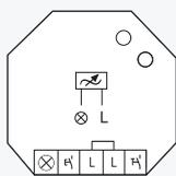
**Sans raccordement N, Power MOSFET jusque 400W. Pertes en attente de 0,7 Watt seulement. Commande par bouton-poussoir ou interrupteur. Valeur de luminosité minimale et la vitesse de variation.**
