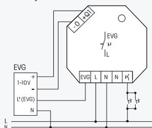
**1 contact NO, non libre de potentiel, 600VA en une sortie de commande 1-10V de 40 mA. Perte en attente de seulement 1 Watt.**
