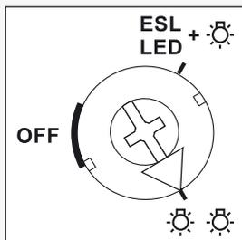
Avec le commutateur dans la position « circuits supplémentaires » (ESL LED) le LUD12 peut aussi fonctionner comme variateur universel et autonome.
