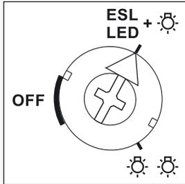
Le commutateur, sur la face avant, doit se trouver dans cette position pour ESL et LED de 230V, lorsque le téléviateur est utilisé dans les positions de confort ESL ou LED. Aussi bien pour augmentation de puissance avec des circuits supplémentaires.
