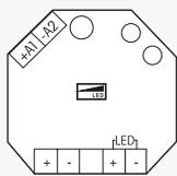
**Source de courant DC constant pour lampes à LED jusqu'à 1000 mA respectivement 30 Watt. Perte en attente de seulement 0,1 Watt. Valeur de luminosité minimale réglable et vitesse de variation réglable. Avec enclenchement chambre d'enfant et de somnolence.**
