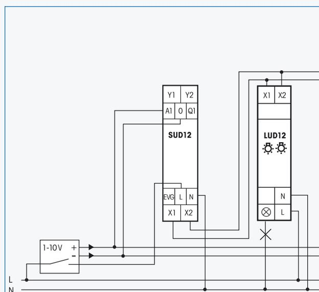
En utilisant cette connexion, et en combinaison d'un module de puissance LUD12 raccordé aux bornes X1-X2, il est possible de transformer la sortie d'un appareil de commande 1-10V aux bornes A1/O vers une fonction de variation directe. La commutation de la charge est effectuée également à l'extérieur à la borne L du SUD12.
