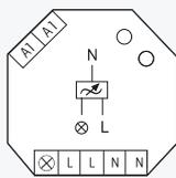
**Télévariateur. Power MOSFET jusque 400 W. Reconnaissance automatique des types de lampes. Pertes en attente seulement 0,1 Watt. Valeur de luminosité minimale et maximale réglable ainsi que la vitesse de variation. Avec enclenchement chambre d'enfant et de somnolence.**
