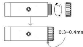
Avant utilisation, s'assurer que le joint d'étanchéité principal (6) ainsi que le joint de fond de bouchon soient correctement en place. Puis visser fermement le bouchon sur le corps de la caméra jusqu'à ce que le joint principal (6) ne soit plus visible que sur 0.3 à 0.4 mm. (force de serrage d'environ 1 kg)
