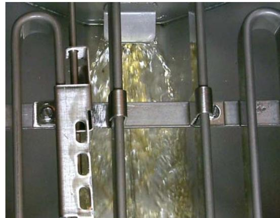
Laissez circuler la graisse végétale/l'huile pendant la durée prescrite pour garantir l'élimination de tous les sédiments et particules en suspension.
