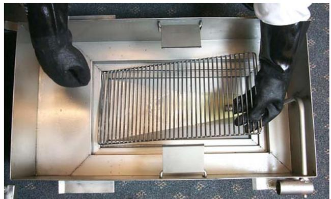
Retirez le tamis métallique du filtre du bac du filtre.
