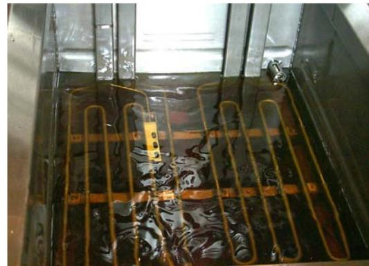
Remplissage de la cuve avec graisse/huile filtrée.
