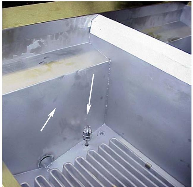
Emplacement de l'interrupteur de sécurité à flotteur.
