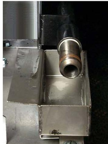
Installation correcte de la cuvette ramasse-gouttes.
