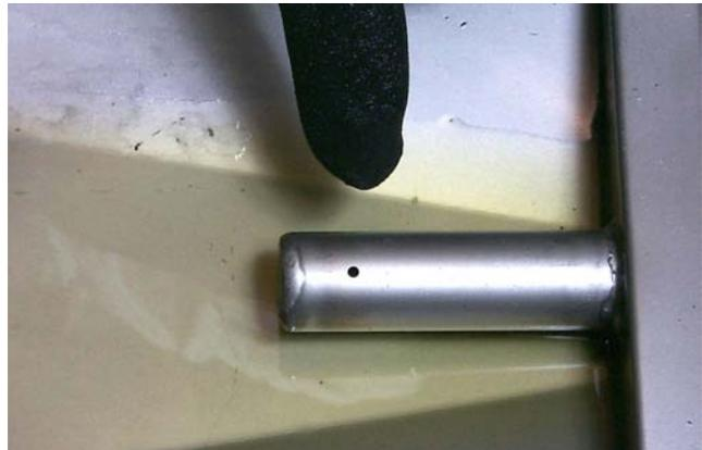
Emplacement du trou de l'évent sur le tube de prélèvement.
