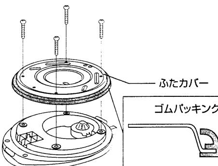
ねじ4本を外し、ふたカバーを外して交換する。
