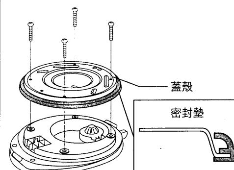
卸下四支螺釘，取下蓋殼，更換密封墊。
