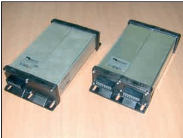
Ordinateurs (nouveau modèle) avec une et deux fiches à 16 pôles
