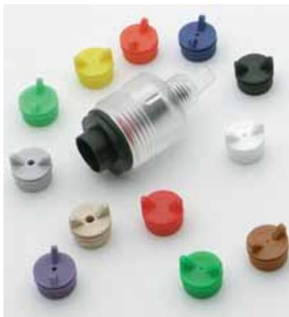
Le choix du dosage venturi se fait en modifiant la dimension de la section d'aspiration du produit. Cette opération est effectuée au moyen de gicleurs de couleur calibrés dont la taille de l'orifice varie.
