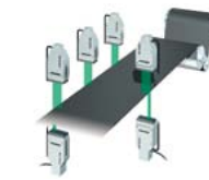
Mesure de la largeur et de la cambrure d'une feuille de caoutchouc
