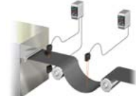
Mesure de l'épaisseur/contrôle de boucle d'une feuille de caoutchouc
