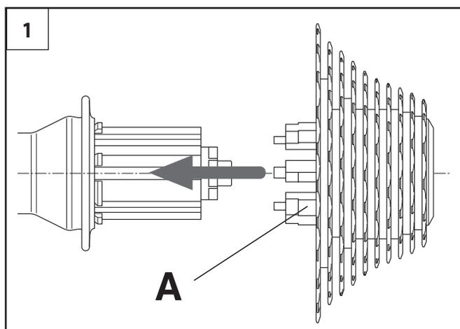
• Insérez le support sur le côté du corps roue libre, alignez les rainures, puis poussez les pignons sur le corps roue libre (Fig. 1). Extrayez le support (A - Fig. 1) du moyeu.
