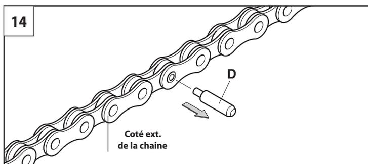
• Le fait que le rivet (E) dépasse légèrement (X) (vers le côté externe de la chaîne) du maillon (Fig. 15) est tout à fait normal et ne gêne pas le glissement normal de la chaîne.
