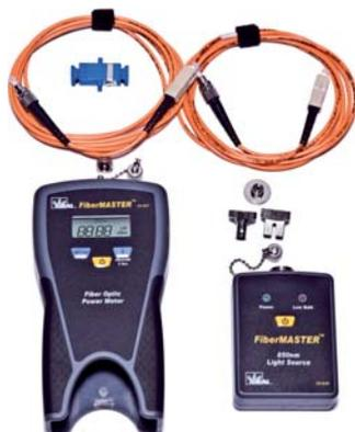
Le FiberMASTER constitué de 2 unités autonomes qui s'emboîtent l'une dans l'autre, permet de mesurer les affaiblissements en multimode en 850nm avec la source incluse (en dB, après réalisation d'un zéro)
