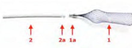
Afb. 2: In elkaar schuiven van de clipsluiting
