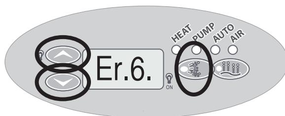
Pour toutes les erreurs 3 à 8, le fonctionnement du spa est interrompu jusqu'à la réinitialisation du système. Cette réinitialisation s'effectue en appuyant simultanément sur les touches ▲, ▼ et POMPE. L'état d'erreur persiste même après le débranchement de l'alimentation.
