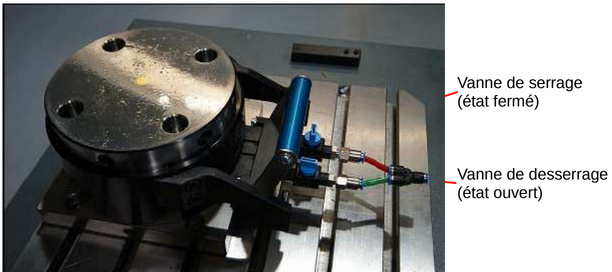
Fig 9 adaptateur pneumatique manuel positionné sur l'embase pneumatique
