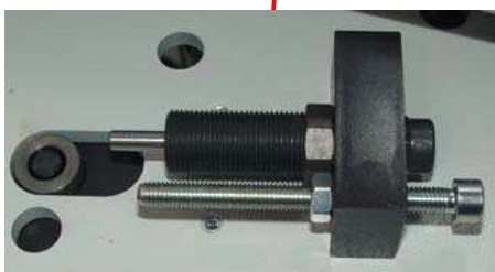
Fig 21 : butée du vérin de rotation
