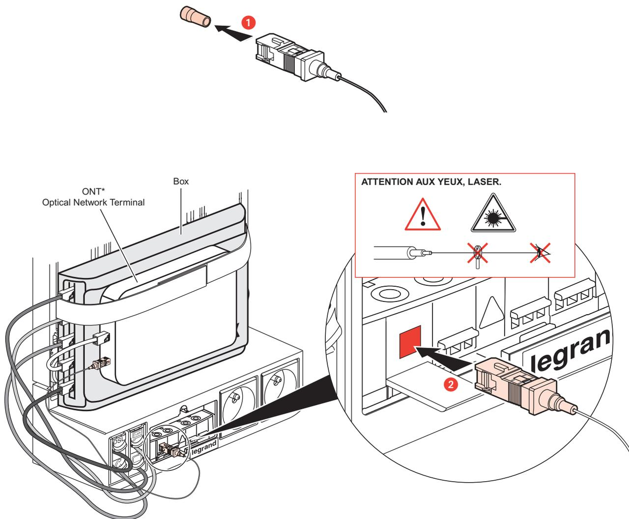
\* Fourni par l'opérateur xDSL si la box ne dispose pas d'entrée optique.
