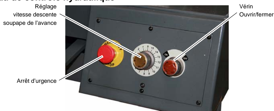
Abb.4-4: Panneaux de contrôle au réservoir
