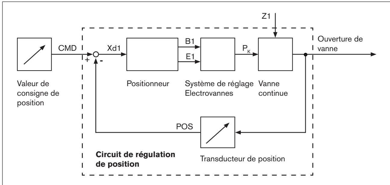
Figure 3 : Schéma logique du positionneur
