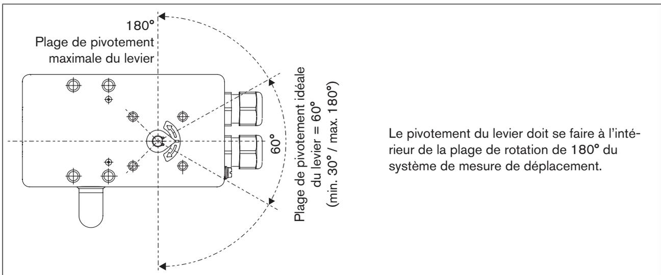
Le pivotement du levier doit se faire à l'intérieur de la plage de rotation de 180° du système de mesure de déplacement.
