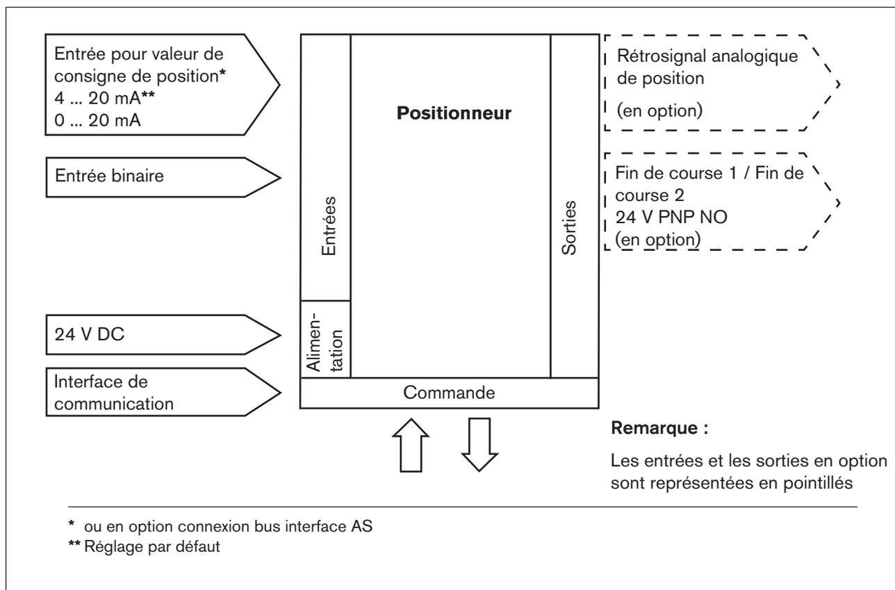
Figure 5 : Interfaces du positionneur
