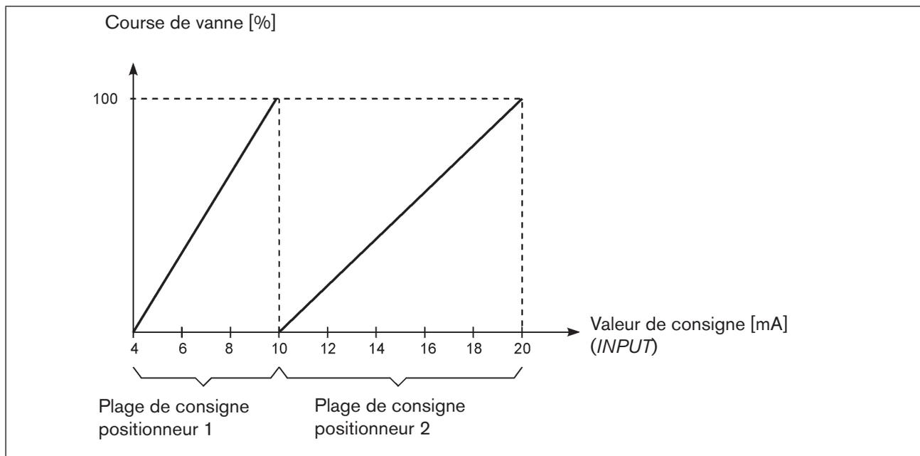
Figure 17 : Diagramme SPLITRANGE
