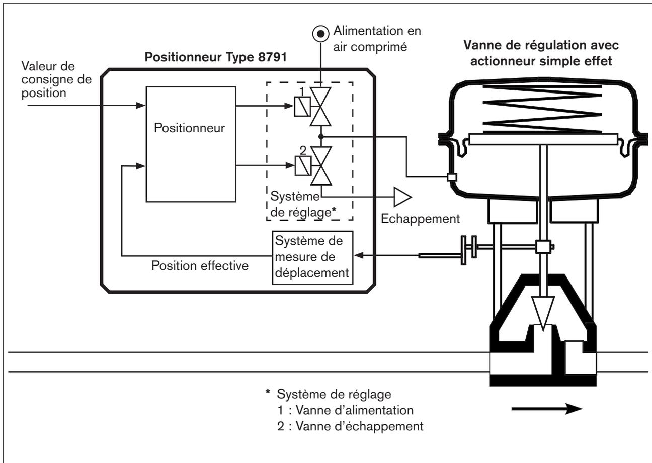
Figure 2 : Schéma fonctionnel, positionneur, type 8791
