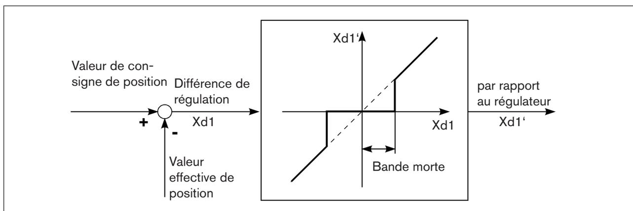
Figure 20 : Diagramme X.CONTROL
