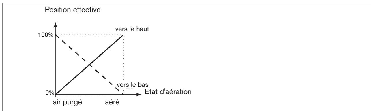
Figure 16 : Diagramme *DIR.ACTUATOR*
