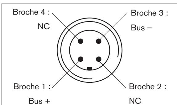
Figure 35 : raccordement bus sans alimentation en tension externe
