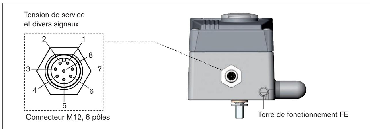
Figure 32 : Désignation des connecteurs ronds et des contacts
