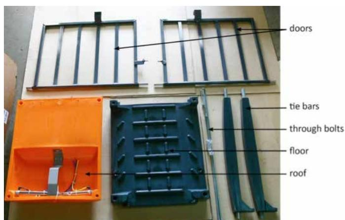
Figure 7. Éléments de l'unité de sélection
