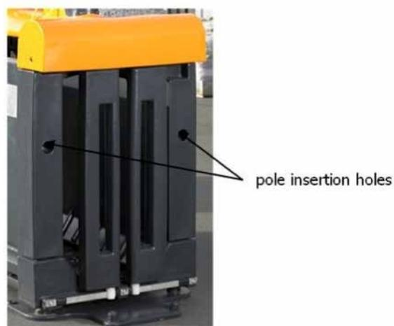
Figure 5. Orifices d'insertion des barres de transport.
