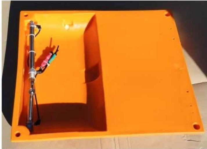
2. Attacher les deux barres de l'armature au dos du toit et les visser avec deux vis (14 x 50mm). Il y a un côté gauche et un côté droit, l'échelon devant se trouver à l'intérieur (voir photo ci-dessous).
