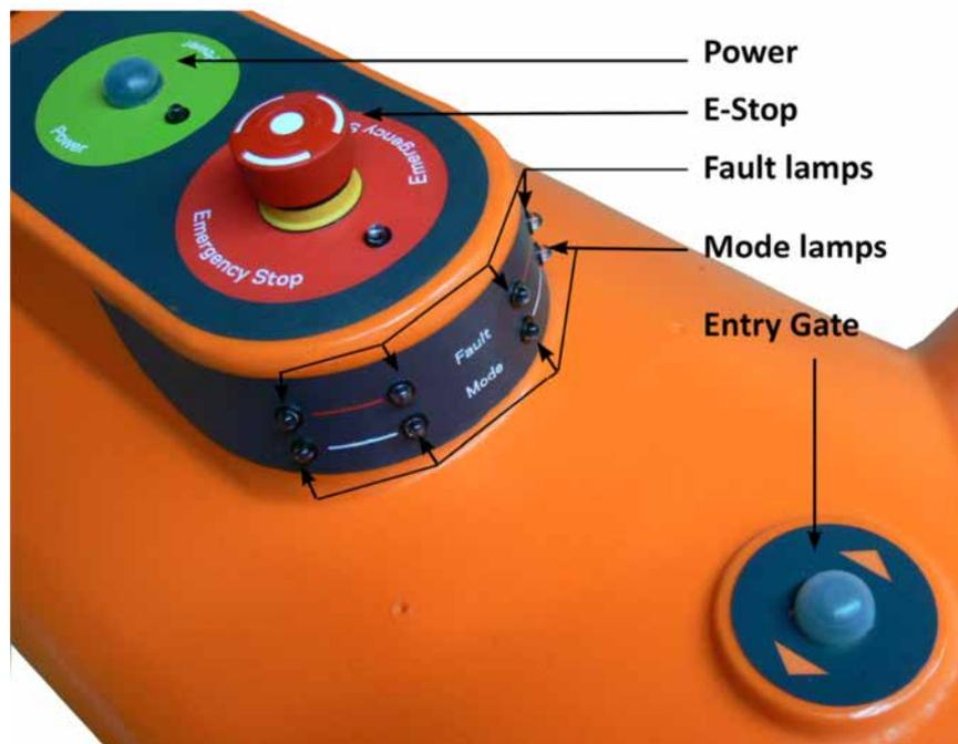
Figure 14. Position des voyants et boutons du pont de commande du Trieur automatique d'ovins
