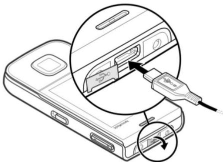
Ouvrez le cache du connecteur USB et connectez le câble USB à l'appareil.
