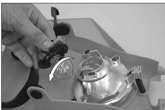
Appuyer légèrement sur l'ampoule et la faire tourner d'environ 30° dans le sens inverse de celui des aiguilles d'une montre. On peut alors la retirer.
