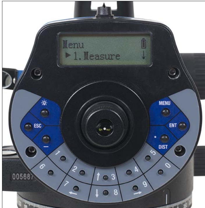
Figure 3.1 Unité de commande et d'affichage du niveau numérique DL-15
