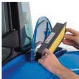
Remplacez ou nettoyez le filtre à air de la cabine en le retirant simplement de son logement situé sur l'aile arrière.
