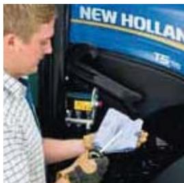
Le niveau d'huile moteur et les orifices de remplissage sont faciles d'accès, sans qu'il soit nécessaire de soulever le capot. Les contrôles de routine sont plus rapides et l'entretien est simplifié.
