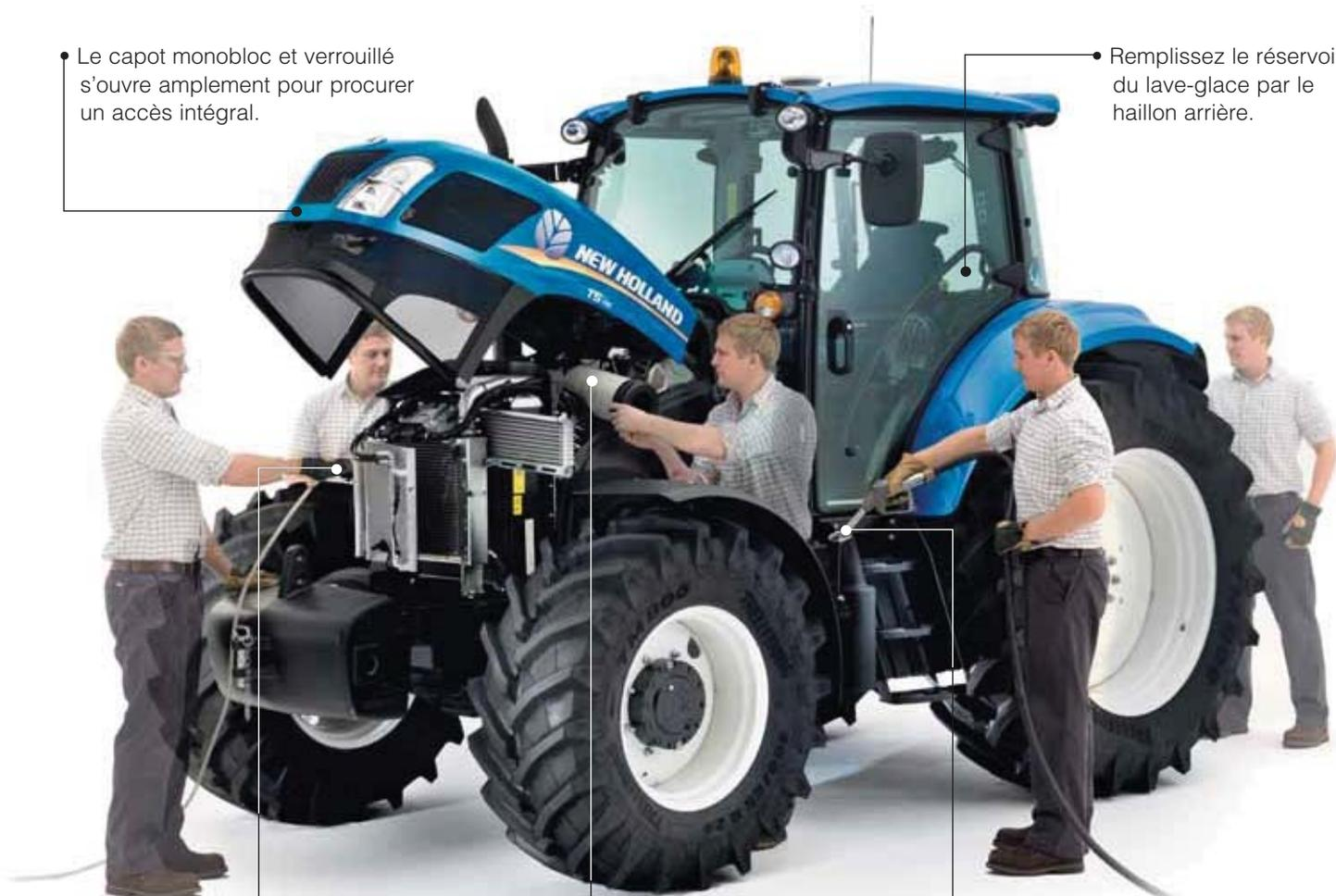
Le radiateur de refroidissement coulisse vers l'extérieur pour un nettoyage simple et efficace.
