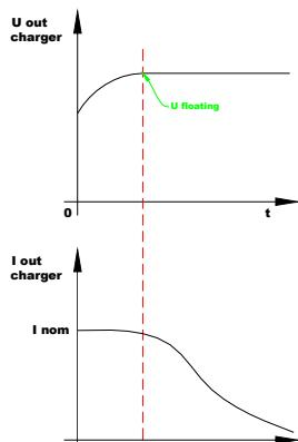
En esta configuración, el cargador CPS3 suministra una curva de carga de tipo mononivel IU. Genera una tensión constante y suministra la corriente necesaria para la o las baterías. El tiempo de carga depende del estado de la batería y es más largo que en la configuración boost en posición ON.
