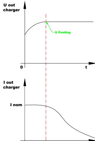
In questa configurazione, il caricabatteria CPS3 eroga una curva di carico di tipo mono-livello IU. Esso genera una tensione costante e fornisce la corrente necessaria alla o alle batterie; Il tempo di ricarica dipende dallo stato della batteria ed è più lungo rispetto alla configurazione boost in posizione ON.
