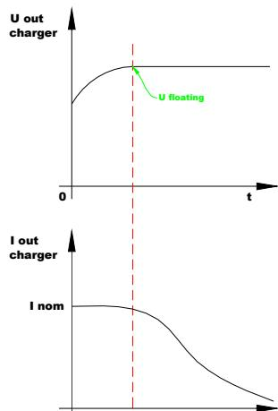
In dieser Konfiguration liefert das Ladegerät CPS3 eine einstufige Ladekurve  $IU$ . Es erzeugt eine konstante Spannung und liefert den für die Batterie(n) notwendigen Strom. Die Aufladezeit hängt von dem Zustand der Batterie ab und ist länger als bei der Konfiguration Boost in Position ON.
