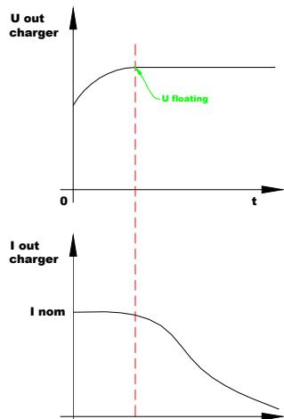
Dans cette configuration, le chargeur CPS3 délivre une courbe de charge de type mono-palier IU. Il génère une tension constante et fournit le courant nécessaire à la ou les batteries. Le temps de recharge dépend de l'état de la batterie et est plus long que dans la configuration boost en position ON.
