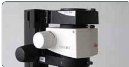
3. Serrez la vis d'arrêt avec précaution, sans forcer.
