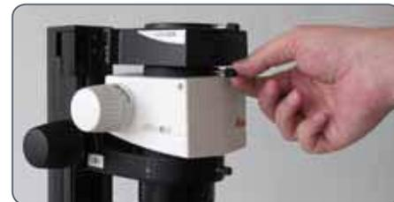
4. Fixez le tube d'observation sur la Leica IC80 HD comme décrit dans le mode d'emploi de votre stéréomicroscope.
