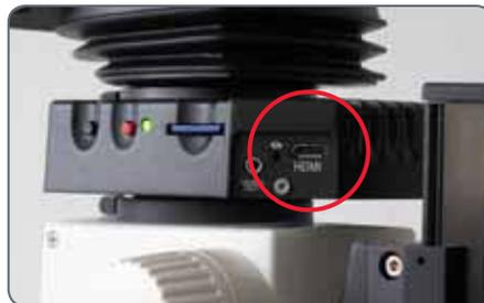
2. Connectez le câble HDMI au téléviseur ou à l'écran HDMI.
