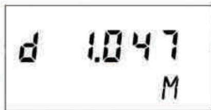
**Niveau (L).** Indique le niveau ou hauteur à partir d'une référence, normalement le fond du réservoir, et la surface du liquide ou solide.
