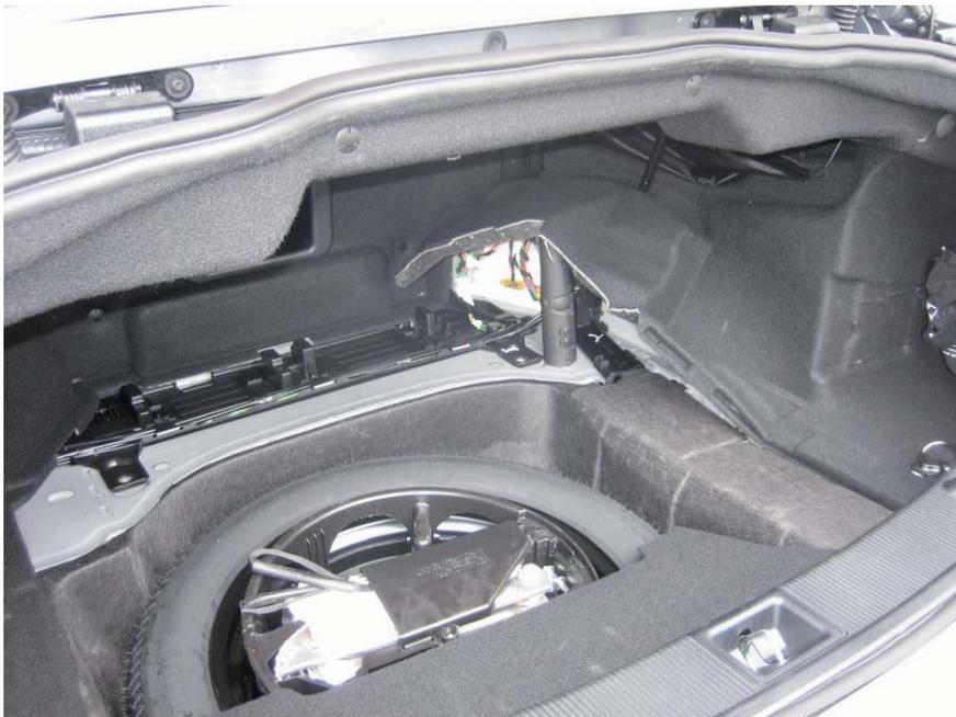
3. Soulevez le couvercle et la moquette dans le coin arrière comme indiqué et la soutenir à l'aide d'un tournevis ou d'une lampe de poche (sur la photo nous avons utilisé une lampe de poche).
