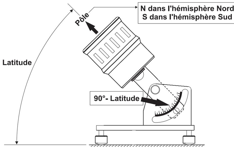
**Fig. 7: orientation du capteur**
