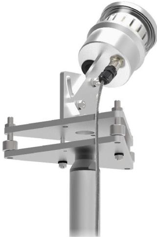
Le capteur d'ensoleillement LP SD18 mesure la durée et l'état d'ensoleillement. Le WMO (World Meteorological Organization) définit la durée d'ensoleillement comme le temps pendant lequel le rayonnement direct est supérieur à  $120 \text{ W/m}^2$ .
