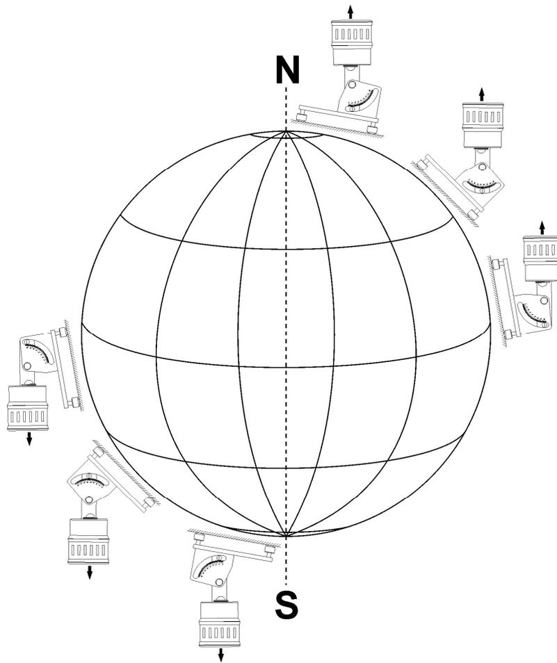
**Fig. 8: le capteur en parallèle à l'axe de la terre**
