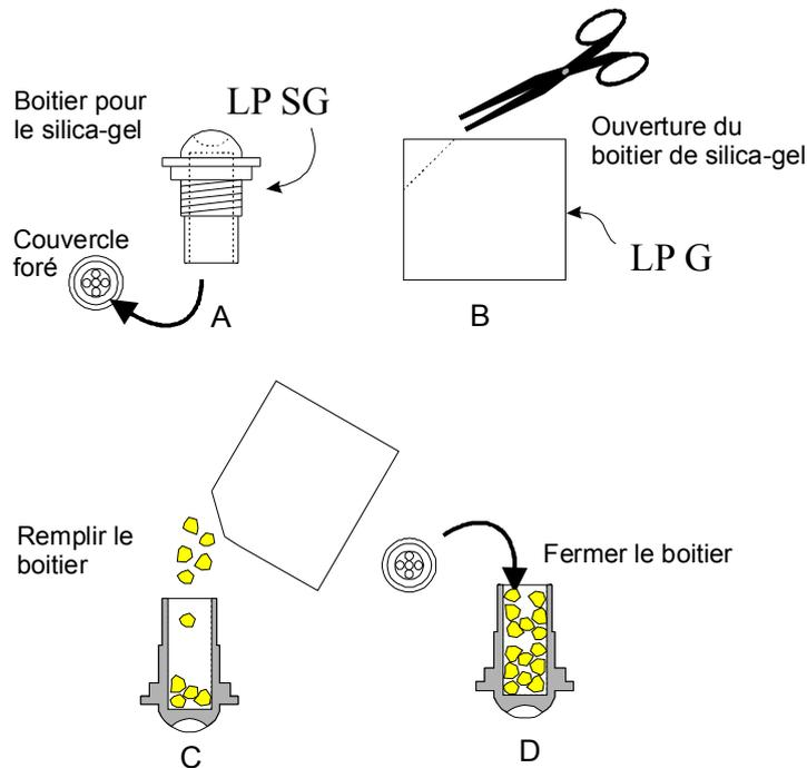
**Fig. 1: chargent cartouche avec cristaux de silica-gel**
