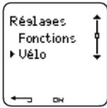
Sélectionnez **Réglages** > **Vélo** > Vélo 1, Vélo 2, Vélo 3 ou Autre. Vélo 2 et Vélo 3 peuvent être activés ou désactivés. Sélectionnez **Autre** pour désactiver les capteurs de vitesse, de cadence et de puissance et pour mesurer les données de fréquence cardiaque, d'altitude et de température uniquement.
