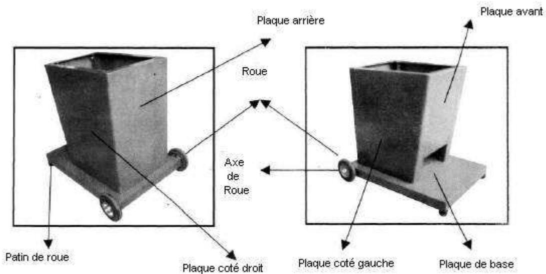
La caisse du corps de la scie contient les pièces suivantes :
