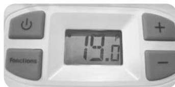
Par un appui bref sur la touche **Fonctions**, positionner l'afficheur de l'écran à cristaux liquide sur **19.0<sup>P</sup>**.
