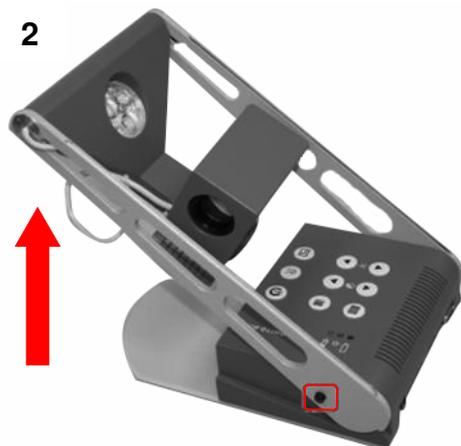
Redresser le bras de support jusqu'au déclenchement du bouton d'arrêt ( voir illustration ) pour que le bras soit enclenché complètement
