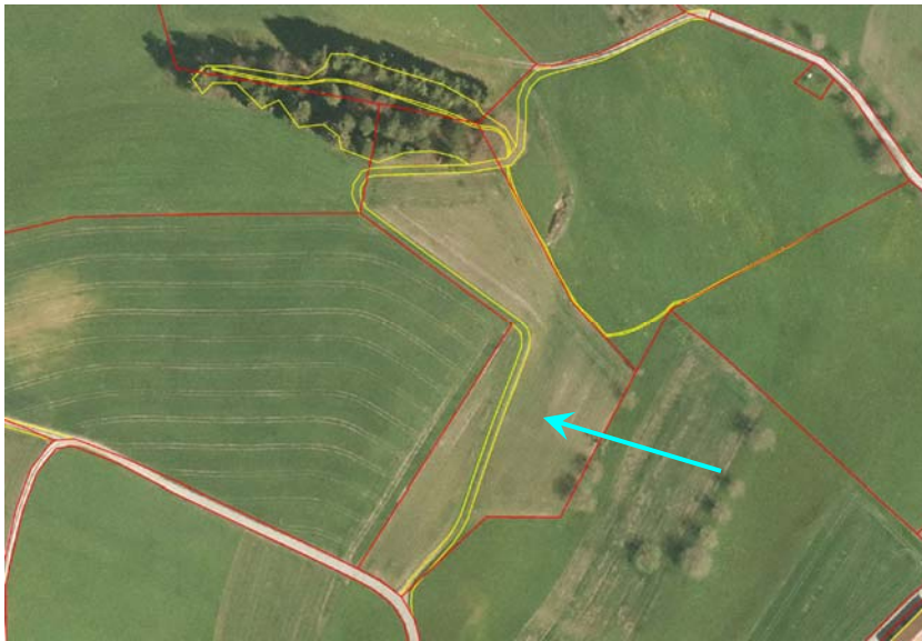
Fig. 8: Les chemins qui ne sont plus visibles sur le terrain doivent être effacés des plans. Exception: les tracés des sentiers pédestres officiels (objets divers de type sentier ).
