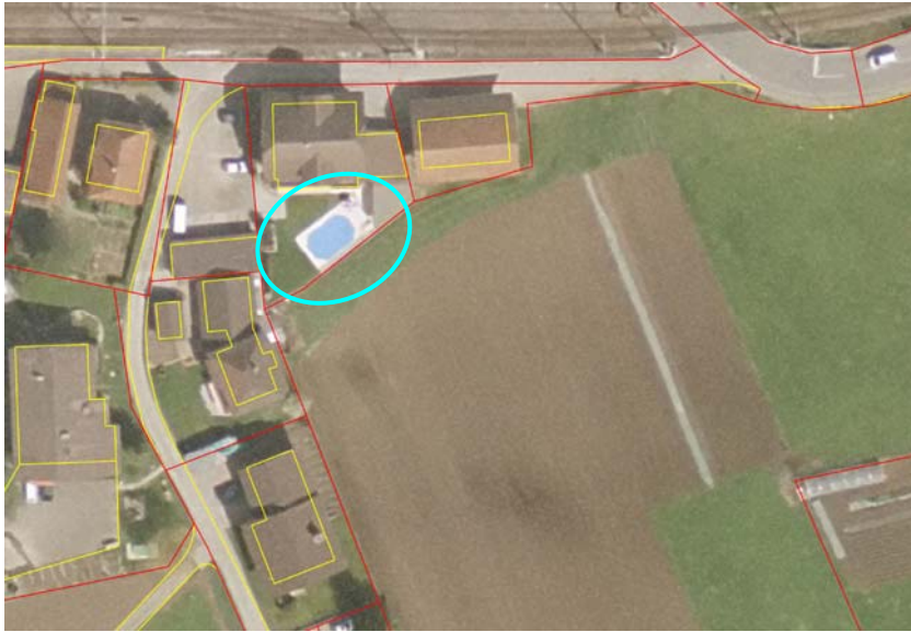
Fig. 17: Les piscines privées sont saisies dans le cadre de la mise à jour permanente si le critère relatif à la surface est rempli.
