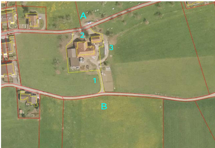
Fig. 18: 1. Les chemins d'accès d'une longueur inférieure à 50 m doivent être saisis dans le genre CS autre_revetement_dur . 2. Les accès privés peuvent être intégrés à la catégorie CS environnante, à savoir ici jardin (pas d'objet spécial du genre « accès »). 3. S'il existe une liaison entre les points A et B, il faut saisir la surface de chemin correspondante (y compris le tronçon 1) comme objet du genre CS route_chemin .
