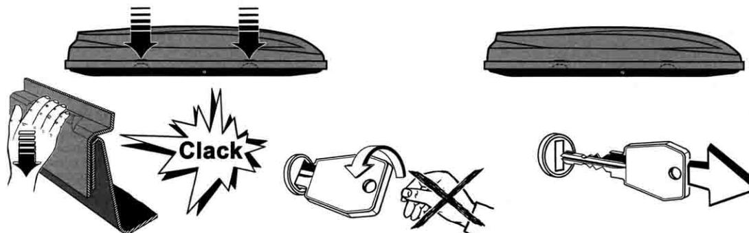
Beim ordnungsgemäßen Verriegeln des Deckels an allen drei Schlossfallen (gleichzeitiges „Clack“) dreht sich der Schlüssel selbsttätig in die Senkrechtkl. Stellung. Der Schlüssel ist nur in der Senkrechtkl. Stellung (verschlossen) abziehbar.
