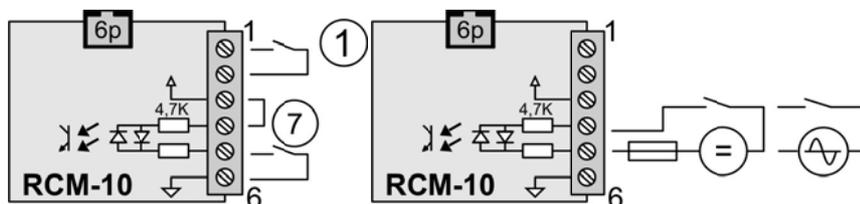
Les bornes 3 à 6 du module RCM-10 sont utilisées comme entrée de commande telle que décrite au chap. 6.2.12 p.26. la fonction dédiée par programmation peut être pilotée par un contact sec (7) entre 5 et 6 avec un pont entre 3 et 4, ou par une tension AC ou DC de max 60 V eff. entre 4 et 5.
