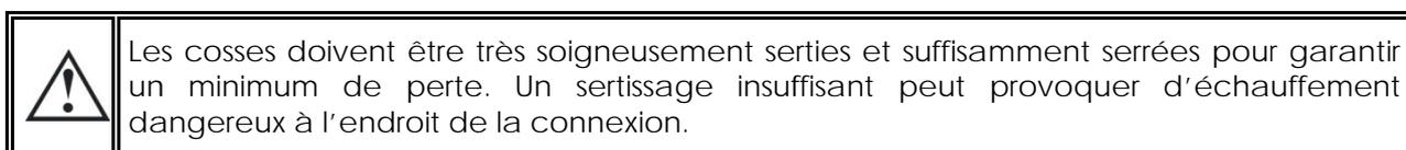
Par sécurité, nous recommandons un contrôle annuel du serrage de toutes les connexions. Sur des installations mobiles, le bon serrage des connexions devrait être contrôlé plus souvent.
