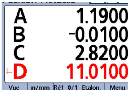
Pour afficher les 4 cotes suivantes(en fonction de votre configuration pièce), appuyer sur la flèche de déplacement " Bas ". Les autres cotes sont visualisées sur l'écran LCD, 4 par 4.
