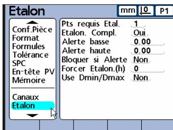
Dans le menu "canaux", à partir de l'entrée E1, aller sur "Résolution". Sélectionner "Etalon"
