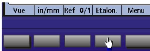
Ex: Dans ce cas, appuyez sur la touche de sélection en dessous de " in/mm " pour activer l'affichage en millimètres ou en pouces : " inch ".
