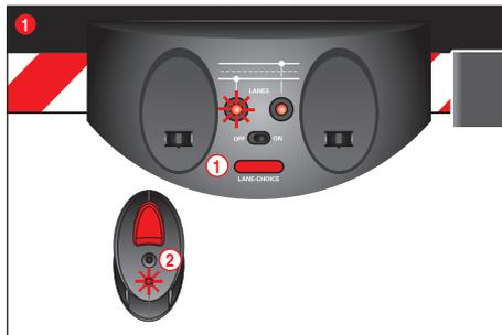
Pour que les commandes manuelles puissent être utilisées pour commander les véhicules, elles doivent toutes être «reliées» au rail de raccord. Mettez le circuit en marche. Les deux LED de contrôle du rail de raccord brillent de manière permanente.
