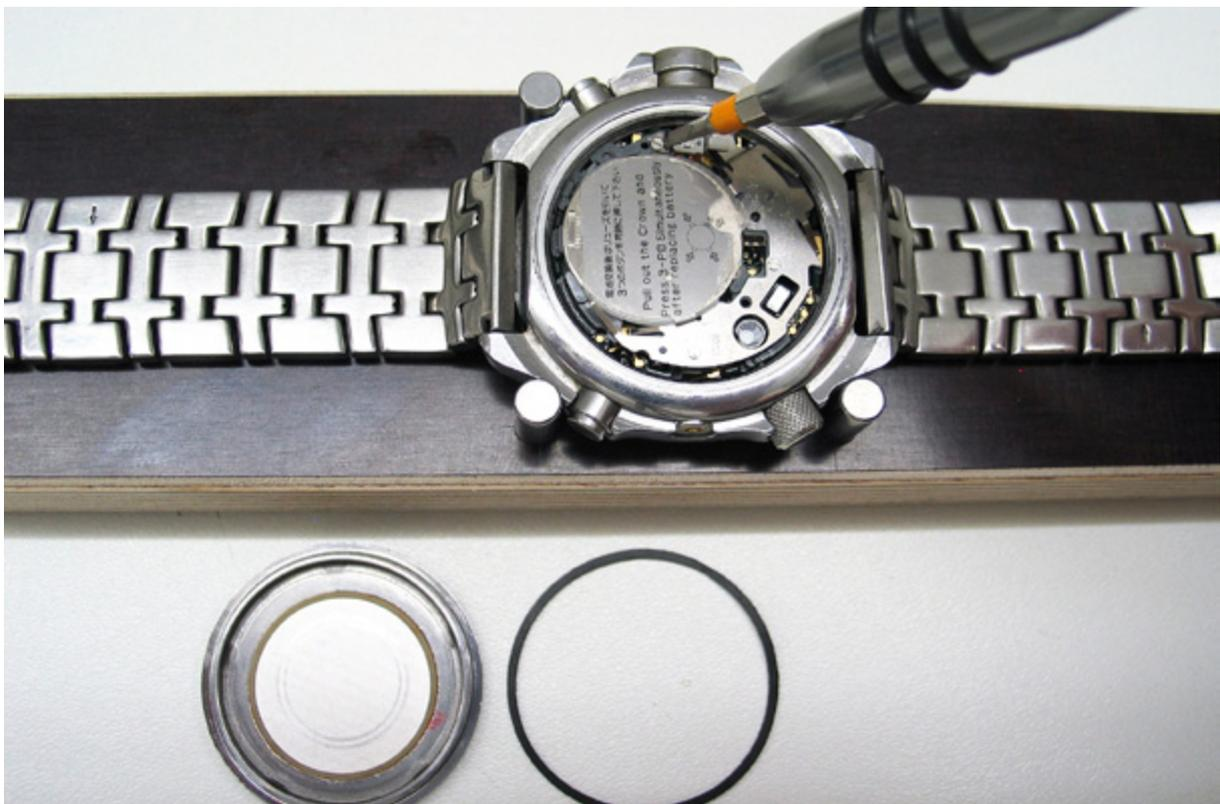
6.1 Remontez le couvercle de maintien de la pile en insérant d'abord l'ergot inférieur, puis passez l'ergot supérieur sous la vis que vous serrez modérément.
