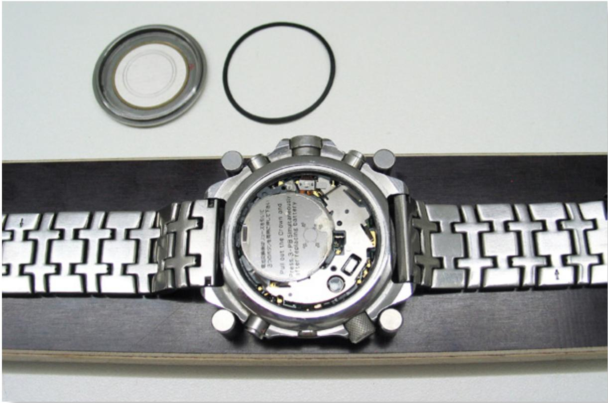
3.1 Sur le fond du boîtier, nettoyez la face d'appui du joint plat avec la pointe d'un tissu sec, ne pas utiliser d'outil, posez le à coté.
