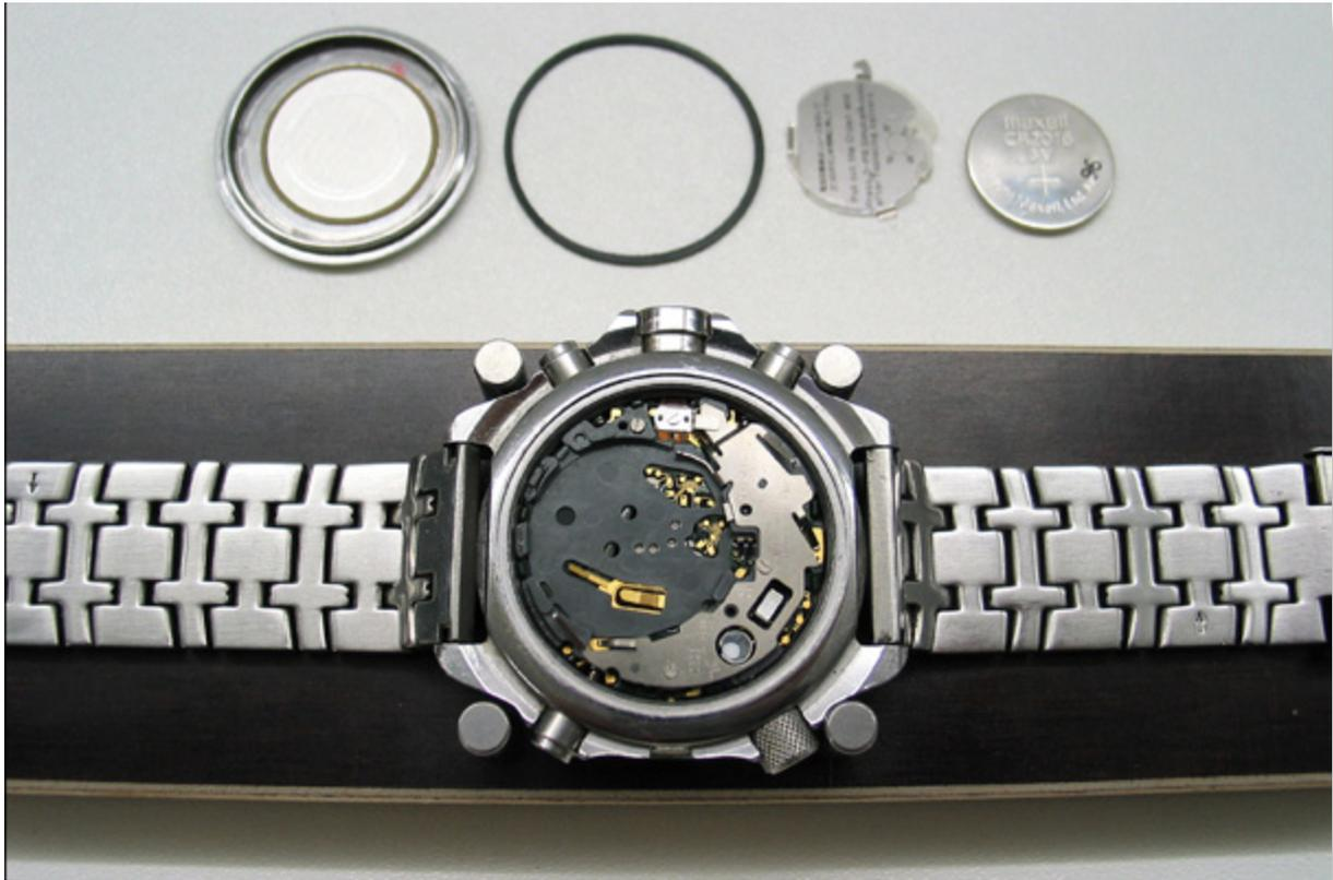
5.0 Sur le boîtier, nettoyez la face d'appui du joint plat avec la pointe d'un tissu sec, ne pas utiliser d'outil.
