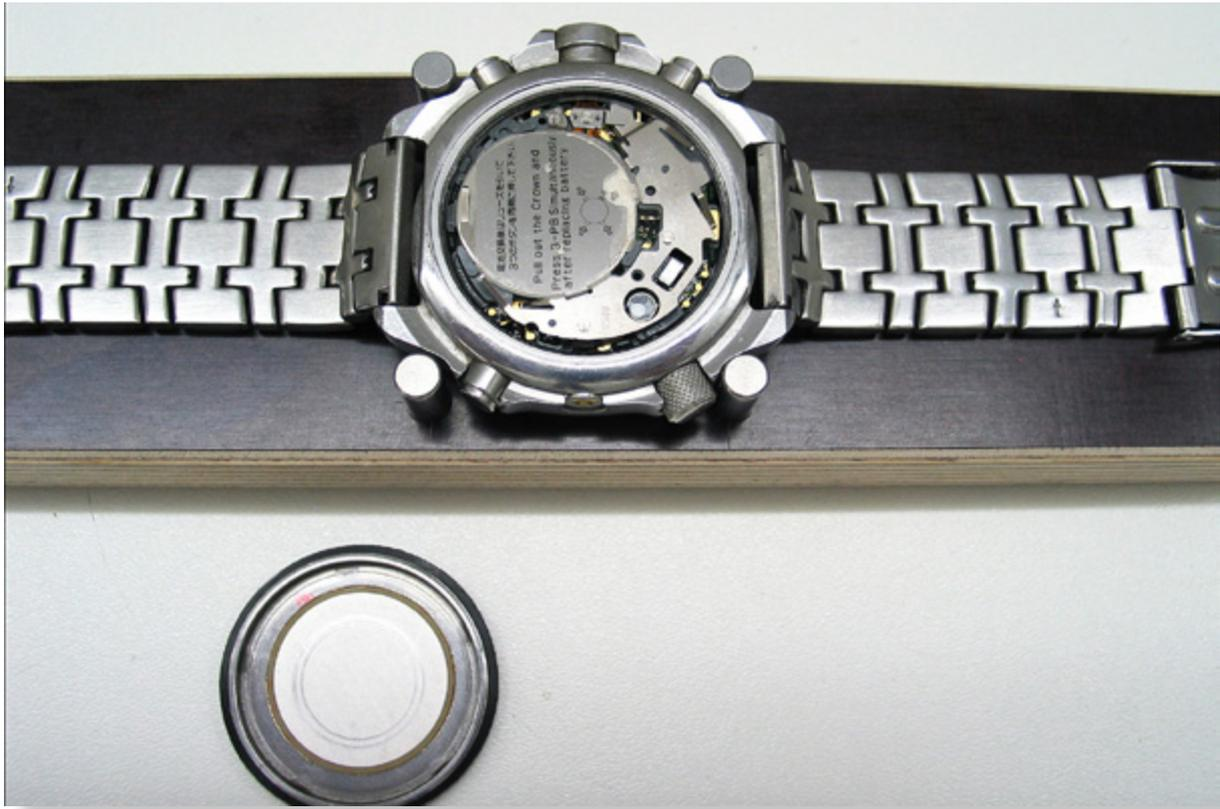
7.0 Placez le joint plat neuf sur le fond du boîtier, vérifiez sa position bien à plat sur la face d'appui. Important! Le joint plat doit être exempt de graisse et de toute particule.
