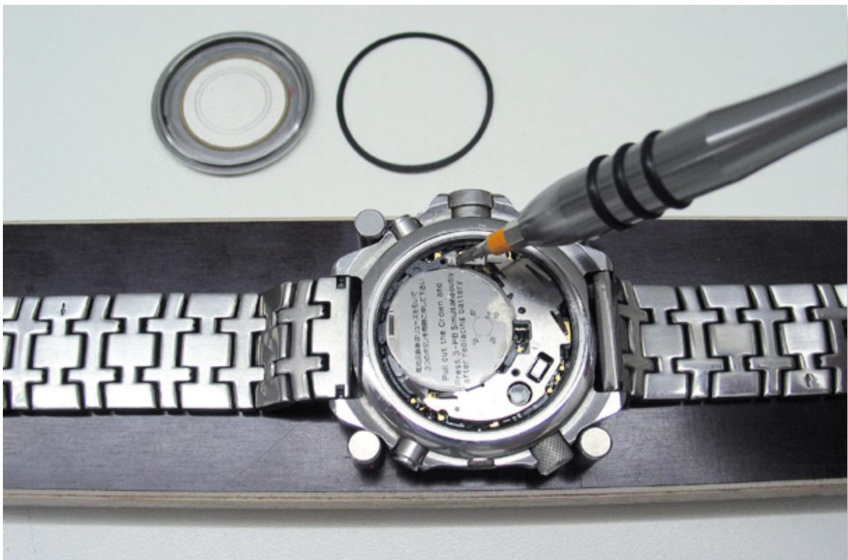
4.0 Avec un tournevis 1.2 à 1.5 mm, dévissez de 1 à 1.5 tour la vis de fixation du couvercle de maintien de la pile.
