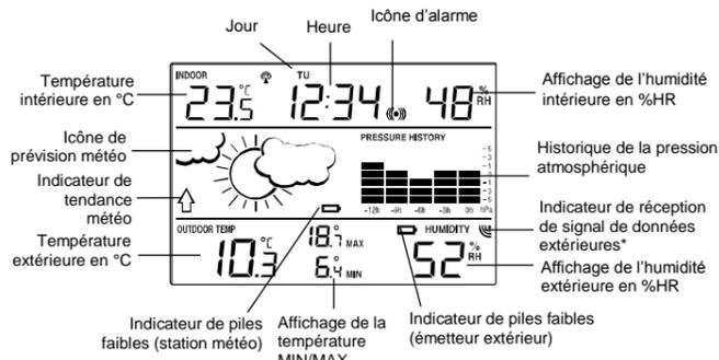
\* Lorsque le signal est réceptionné par la station, l'indicateur de réception du signal extérieur reste affiché à l'écran (l'icône ne sera pas affichée si la réception échoue). L'utilisateur peut ainsi s'assurer de la bonne réception du signal (icône affichée) ou de l'échec de réception (icône absente).
