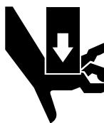
Danger lié aux mouvements. Le vérin à sertir fonctionne à grande vitesse et exerce une grande pression et peut causer des blessures graves. Gardez toute partie du corps loin des pièces en mouvement de l'appareil, particulièrement de la zone T de passage de la tête et du support de la matrice lors du fonctionnement de l'appareil.
