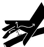
Fluide hydraulique sous pression. NE PAS utiliser une partie quelconque du corps pour localiser une fuite hydraulique. Le fluide hydraulique qui s'échappe sous pression peut causer des blessures graves ou la mort. En cas de blessures provoquées par une fuite de liquide hydraulique, demandez immédiatement des soins médicaux pour éviter des séquelles physiques graves.
