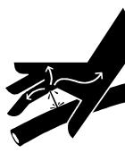
Líquido hidráulico a presión. NO use ninguna parte de su cuerpo para detectar fugas hidráulicas. El líquido que escapa a presión puede causar lesiones graves o la muerte. Si se escapa el líquido a presión y se causa heridas, busque inmediatamente atención médica para evitarse lesiones graves.
