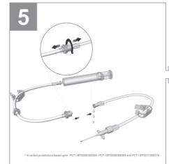
5. Evitez l'injection sous-cutanée ou une extravasation. Vérifiez la circulation du sang et pour cela, desserrez le raccord du clapet anti-retour du côté du patient. Fixez le tuyau de raccordement pour aspiration et faites en sorte d'évacuer l'air.
