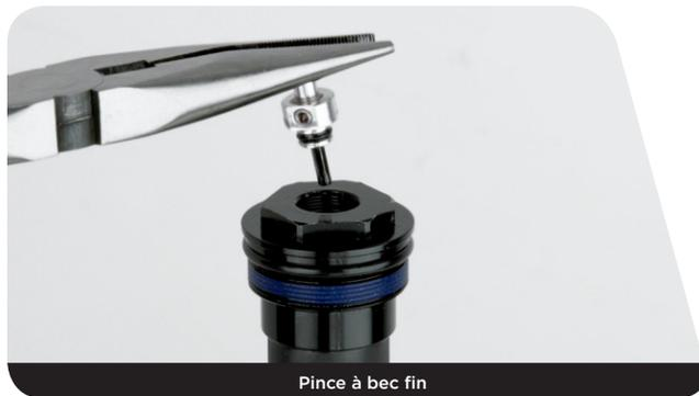
**20** Avec les doigts ou une pointe, retirez le joint torique situé sur le régleur de compression basse vitesse.
