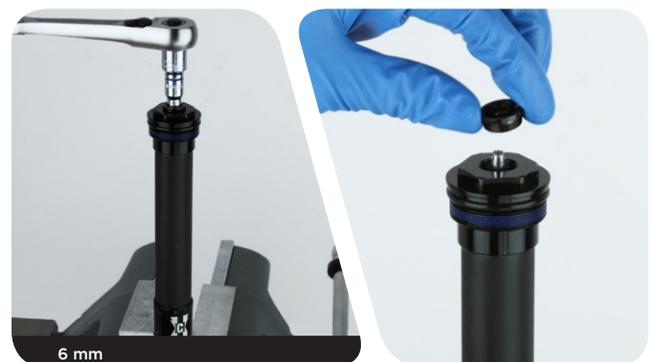
**19** À l'aide d'une pince à bec fin, retirez le régleur de compression basse vitesse hors du capuchon supérieur de compression.
