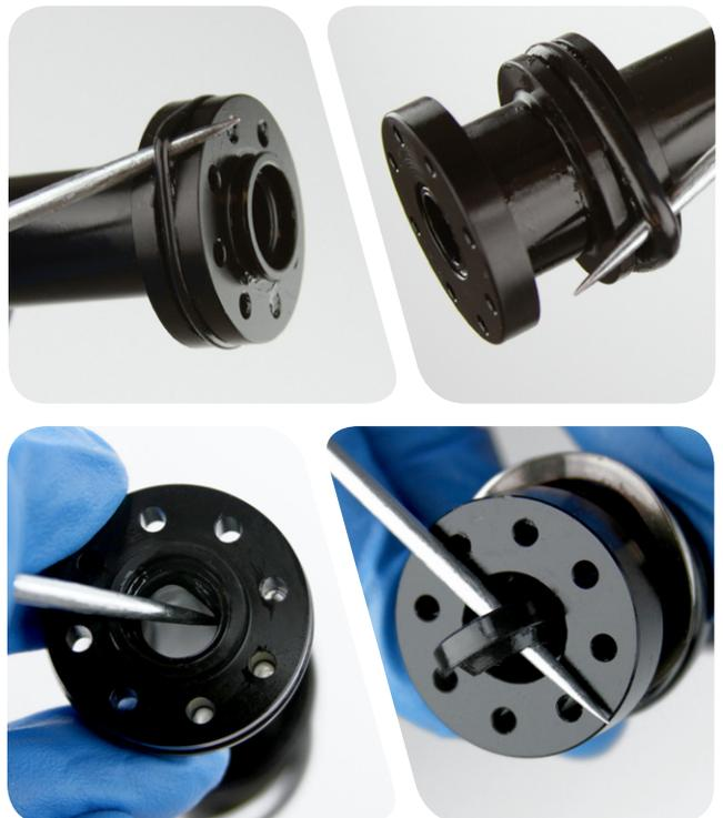
**10** Avec les doigts ou une pointe, retirez l'anneau de section carrée et les bagues d'appui du piston pneumatique. Avec les doigts, installez un joint torique de section carrée et des bagues d'appui neufs.
