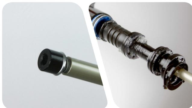
**7** Vaporisez de l'alcool isopropylique sur l'intérieur et l'extérieur du tube supérieur puis nettoyez-le avec un chiffon.
