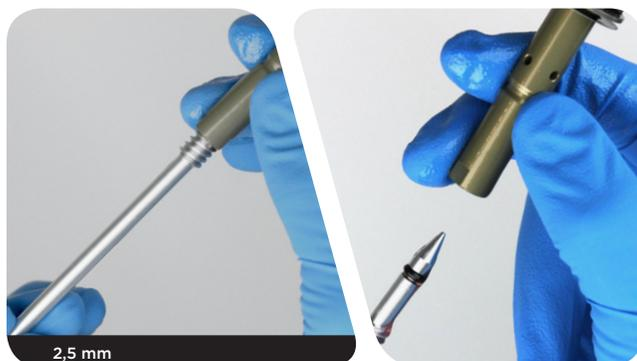
**23** Avec les doigts ou une pointe, retirez le joint torique de l'aiguille de compression basse vitesse.
