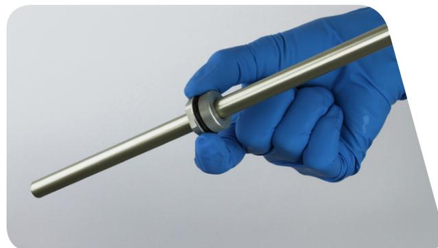
**12** Avec les doigts ou une pointe, retirez le joint torique externe de la tête d'étanchéité de l'amortisseur du rebond. À l'aide d'une pointe, piquez et retirez le joint d'étanchéité.
