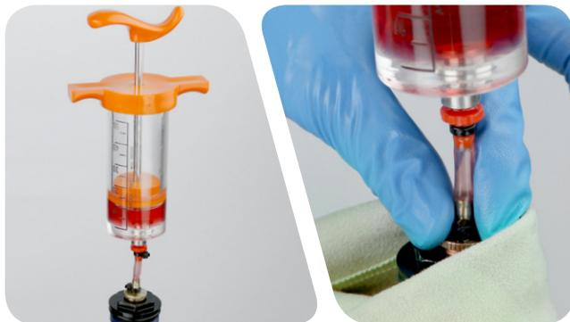
**24** Avec les doigts, installez le régleur de compression basse vitesse dans le capuchon supérieur de compression.
