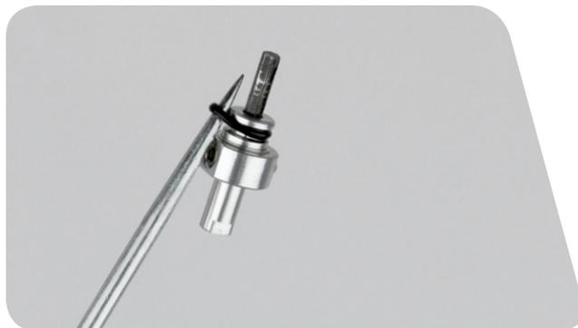
**21** Avec les doigts ou une pointe, retirez le joint torique du piston de compression.
