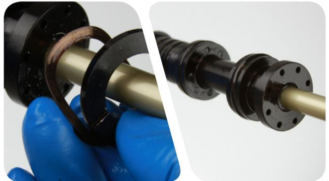
**9** Avec les doigts ou une pointe, retirez les joints toriques externes de la tête d'étanchéité. Avec une pointe, piquez et retirez le joint torique interne et le joint d'étanchéité. Avec les doigts, installez les joints toriques et d'étanchéité neufs.
