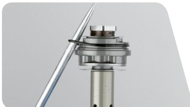
**22** À l'aide d'une clé hexagonale de 2,5 mm ou avec les doigts, retirez l'aiguille de compression basse vitesse.
