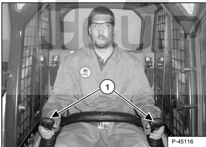
Les deux manipulateurs commandent l'entraînement et la direction et sont situés à droite et à gauche à l'avant du siège (1) [Figure 23].
