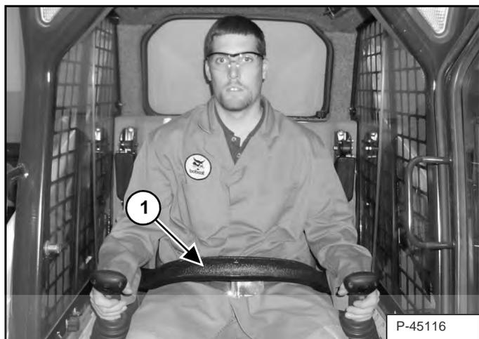
Le dispositif de retenue de l'arceau de siège comprend un arceau de siège pivotant avec accoudoirs (1) [Figure 13].
