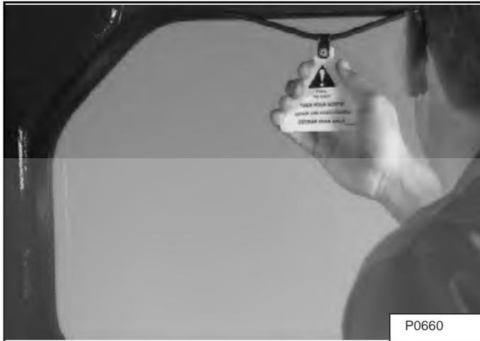
Tirez sur la languette en haut de la vitre arrière pour retirer la garniture en caoutchouc [Figure 68].
