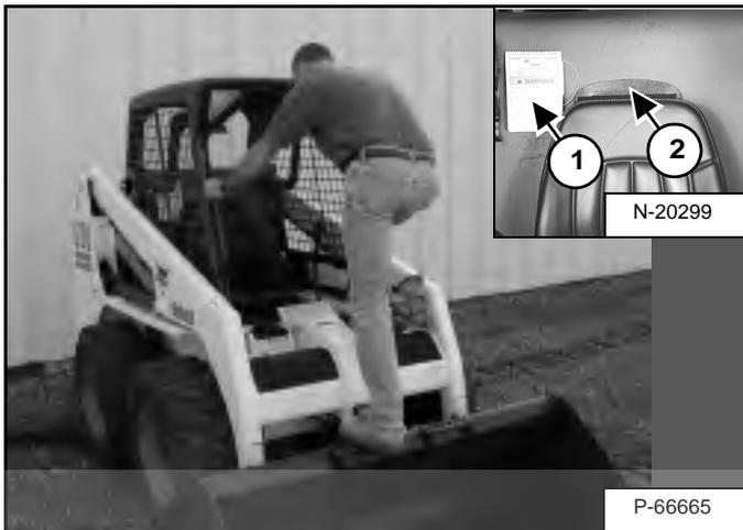
Utilisez les marchepieds du godet ou de l'accessoire, les mains courantes et l'antidérapant (sur les bras de levage et le châssis de la chargeuse) pour monter et descendre de la chargeuse [Figure 47]. Ne sautez pas.
