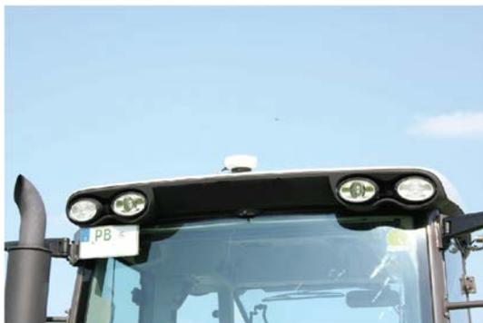
Récepteur GPS sur le toit d'un tracteur
