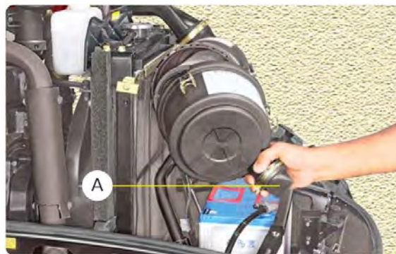
Valve de décharge du dépoussiéreur
