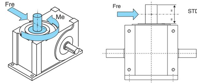
Fre = Forza radiale entrata (N)/ Input radial force (N)/Radialkraft Antrieb (N)/Force radiale en sortie (N)/ Fuerza radial de entrada (N)
