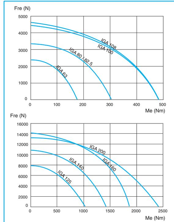
I diagrammi indicano le curve relative ai valori massimi di (Fre/Me) per l'albero in entrata/uscita. I valori indicati sono riferiti ad una velocità di rotazione dell'albero di 100 rpm.
