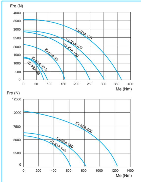
Carichi sull'albero in uscita IGA / Loads on IGA output shaft / Belastungen der Ausgangswelle / Charges sur l'arbre de sortie / Cargas sobre eje de salida
