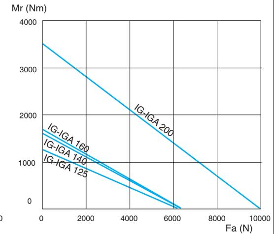
Carichi sull'albero in entrata / Loads on the input-shaft / Belastungen der Eingangswelle / Charges sur l'arbre d'entree / Cargas sobre eje de entrada
