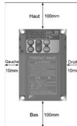
Figure 3.1 Instructions de montage et distances d'isolement requises
