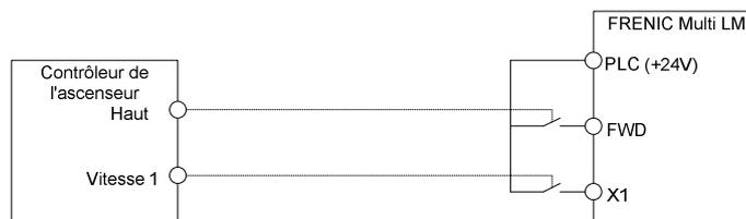
Illustration 4.8 Connexion normale utilisant les contacts libres de potentiel du contrôleur de l'ascenseur
