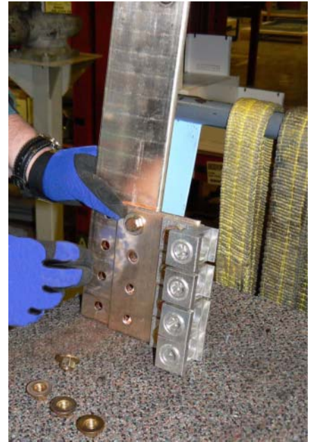
C. Montez le panneau de cosses sur le même côté de l'entretoise, mais dans la direction opposée, tel qu'illustré.
