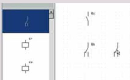
Lorsque les symboles sont posés sur le schéma, un marquage automatique permet de savoir à quel appareil ils appartiennent. Les composants provenant d'un appareil de puissance sont accompagnés du repère de cet appareil.
