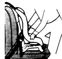
Appliquez une pression sur le siège d'auto avec le genou de façon à ce qu'il s'enfonce dans la banquette de l'auto et serrez la ceinture de sécurité jusqu'à ce que le siège ne puisse se déplacer de plus de 2,5 cm (1 po), vers l'avant ou vers les côtés, à l'endroit où est fixée la ceinture de sécurité. Quand le siège est orienté vers l'arrière, il est normal de pouvoir soulever le siège vers l'arrière du véhicule ou de le faire pivoter de gauche à droite.
