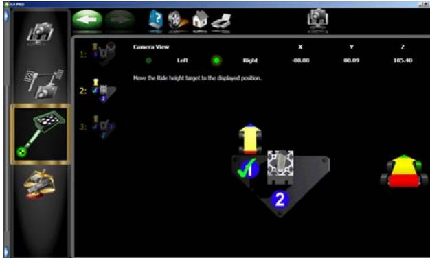
6. Le bouton <SUIVANT> s'allume lorsque la cible est acquise. Cliquer sur le bouton <SUIVANT>, une coche apparaît pour indiquer à l'opérateur qu'il peut passer à l'étape 2.
