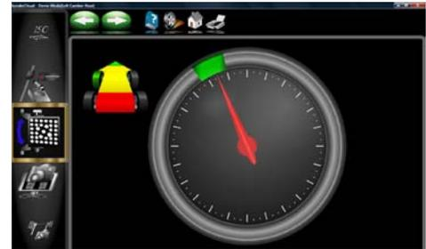
3. Lorsque la roue atteint le point souhaité, un signe d'arrêt s'affiche au centre de la roue. Maintenir la roue immobile pendant la lecture de l'appareil.
