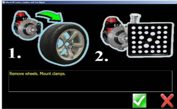
Déposer les roues qui requièrent une intervention et monter le bloc de serrage/cible sur le disque de frein.
