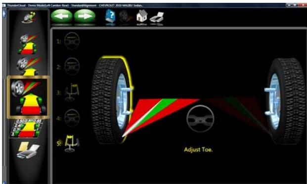
8. Cliquer sur Suivant lorsque le réglage de pincement à gauche est terminé.
