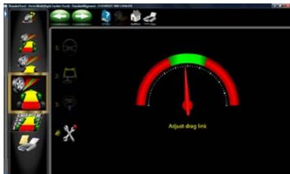
4. Régler le manchon de biellette de direction jusqu'à ce que la direction soit complètement droite, comme indiqué sur l'afficheur du compteur inférieur. Cliquer sur Suivant lorsque le réglage est terminé.
