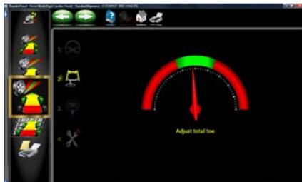
2. Régler la biellette de direction par rapport aux spécifications de pincement total en examinant le compteur supérieur. Cliquer sur Suivant.
