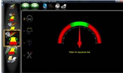
1. Guider les roues avant pour égaliser le pincement en ramenant le compteur inférieur dans la zone verte. Cliquer sur Suivant.
