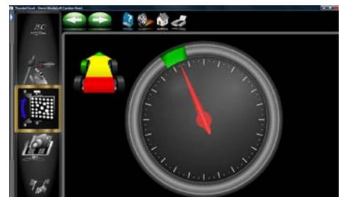
1. Une fois l'identification réussie de la cible, un message indiquant d'abaisser la roue s'affiche. Cela n'est pas nécessaire si la cible du côté opposé doit être identifiée, cliquer sur le bouton **<OK>** et sélectionner la cible suivante. Abaisser les roues lorsque les quatre cibles ont été identifiées.
