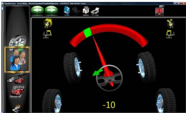
Alors que le volant tourne en pointant vers chaque position de mesure, l'indicateur vert en haut du compteur relève le mouvement de la roue. Les positions de mesure de l'angle de chasse et la SAI (valeur de compensation d'inclinaison) gauches et droites sont à environ +10° et -10°, alors que les positions d'ouverture dans les virages (TOOT) sont à environ +20° et -20°.
