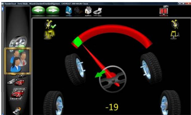
Lorsque les roues sont dans la bonne position, la bande du compteur devient d'abord jaune puis verte lorsque la position est atteinte. Lorsque toutes les mesures sont effectuées, une bande verte apparaît autour de l'icône, l'icône est désenclenchée, la barre d'état devient verte.
