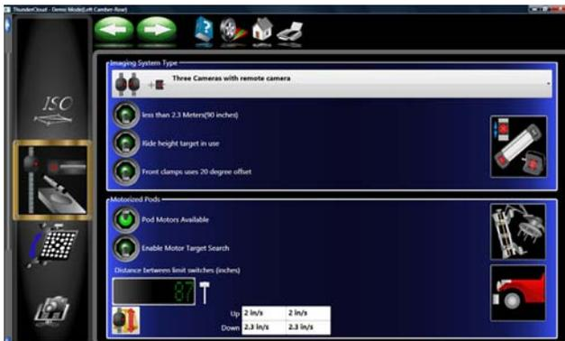
Puis sélectionner la distance d'installation de la caméra. L'installateur est chargé de régler ces valeurs.
