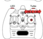
Mit dem Gashebel wird die Höhe des Helikopters gesteuert - den Knüppel sehr behutsam bewegen! Sobald der Helikopter eine stabile Flughöhe (z.B. 1m) erreicht hat, reicht leichtes Bewegen des Knüppels nach oben, um den Helikopter steigen zu lassen. Ziehst du den Hebel zurück so verliert der Hubschrauber an Höhe.
