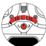
Dreht sich der Helikopter nach dem Start um die eigene Achse wird er durch Drehen am Trimmrad in der Mitte der Fernbedienung justiert und die Fluglage stabilisiert.
