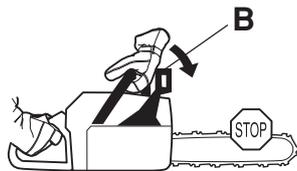
Ce mouvement active mécaniquement un ressort qui tend le ruban du frein (C) autour du système d'entraînement de la chaîne, autrement dit le "tambour d'embrayage" (D).
